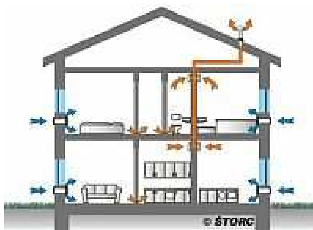
Obr. 5. Princip řízeného větrání
